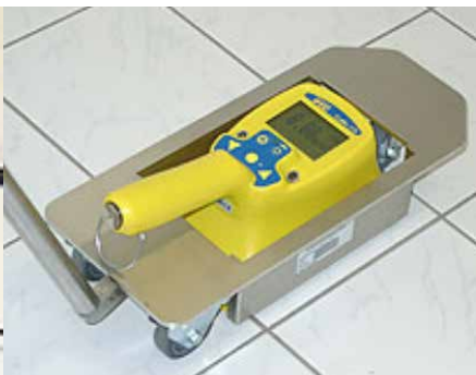
CoMo-170 mit Fußbodenkontrollvorrichtung
